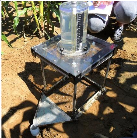
2. ábra. Eijkelkamp 09.06 típusú esőztető berendezés
